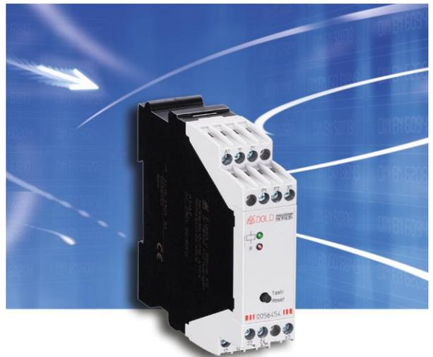
Das Thermistor-Motorschutzrelais MK 9003 ATEX in der Ausführung mit nullspannungssicherer Fehlerspeicherung speichert zudem die Fehlermeldung auch bei Netzausfall. Das Zurücksetzen der Fehlermeldung bei Spannungswiederkehr erfolgt dann über die Reset-Taste am Gerät oder über den Fern-Reset.
