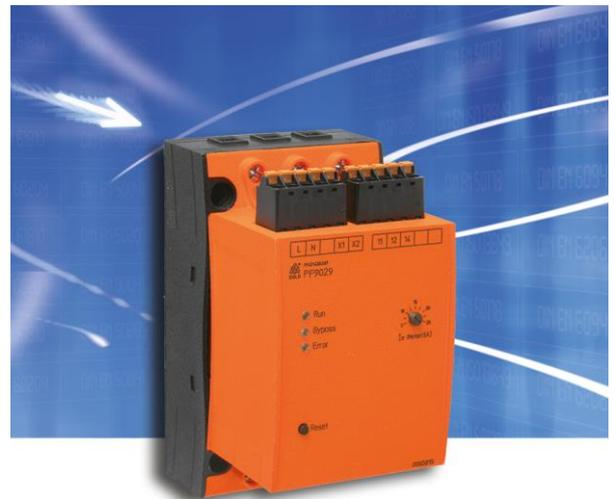
Das kompakte 3-phasengesteuerte Sanftanlaufgerät PF 9029 ermöglicht einen ruckfreien, geräuscharmen und sanften Start bei einem minimierten Anlaufstrom. Die beim Schalten störenden Stromspitzen und Momentschläge werden hierdurch reduziert. Dies erhöht die Lebensdauer der Motoren und mechanischen Antriebskomponenten. Außerdem wird durch die Überbrückung der Leistungshalbleiter nach erfolgtem Sanftanlauf, eine Energieeinsparung erzielt.
