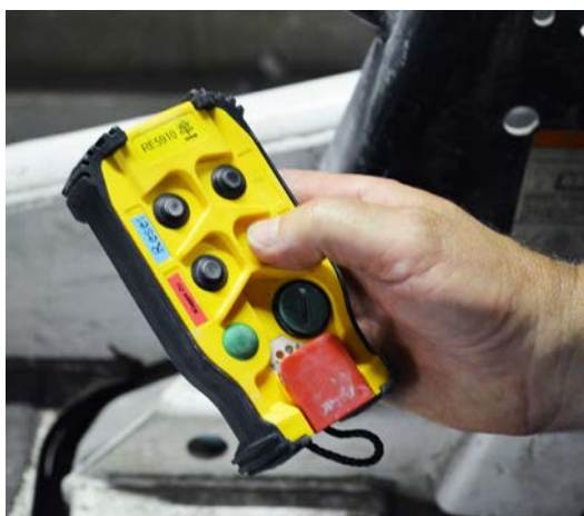
Der Bediener bestätigt auf dem Handsender das Öffnen der Klappe des Massenabwurfs.
