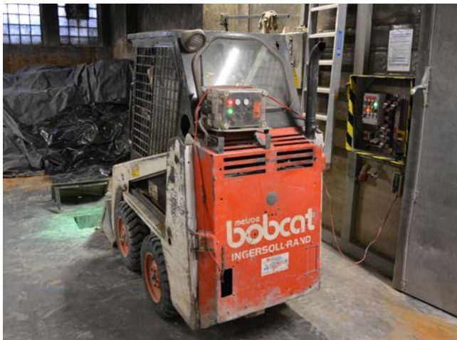
Das Material wird mit einem kompakten Radlader durch den Massenabwurf in den Extruder für die Strangpressanlage befördert.
