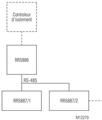
**Detection des défauts d'isolement avec Modbus-Master externe**
