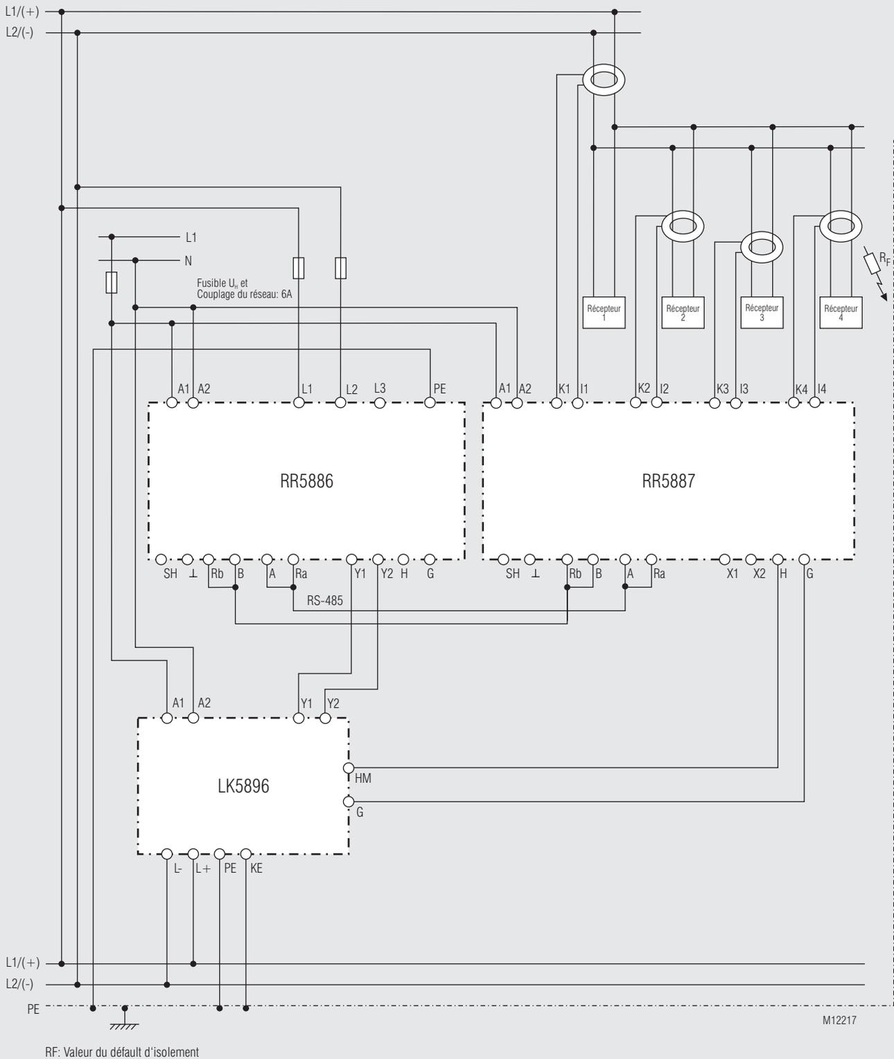
Surveillance de l'isolement et recherche d'erreurs d'isolement avec 4 transformateur d'intensité connectés dans un réseau AC (DC) avec distribution secondaire - la recherche des défauts d'isolement peut être commandée par le contrôleur d'isolement (LK 5896); terminaison du bus du premier et du dernier appareil au bus RS-485
