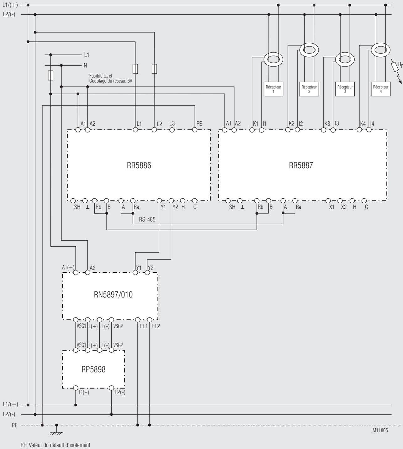
Surveillance de l'isolement et recherche d'erreurs d'isolement avec 4 transformateur d'intensité connectés dans un réseau AC (DC) avec distribution secondaire - la recherche des défauts d'isolement peut être commandée par le contrôleur d'isolement (RN 5897/010); terminaison du bus du premier et du dernier appareil au bus RS-485
