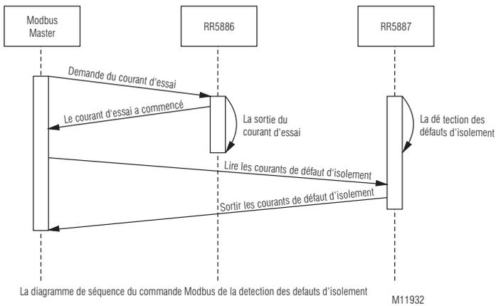
**Exempl. de télégr. du comm. Modbus de la detect. des def. d'isolem.**
