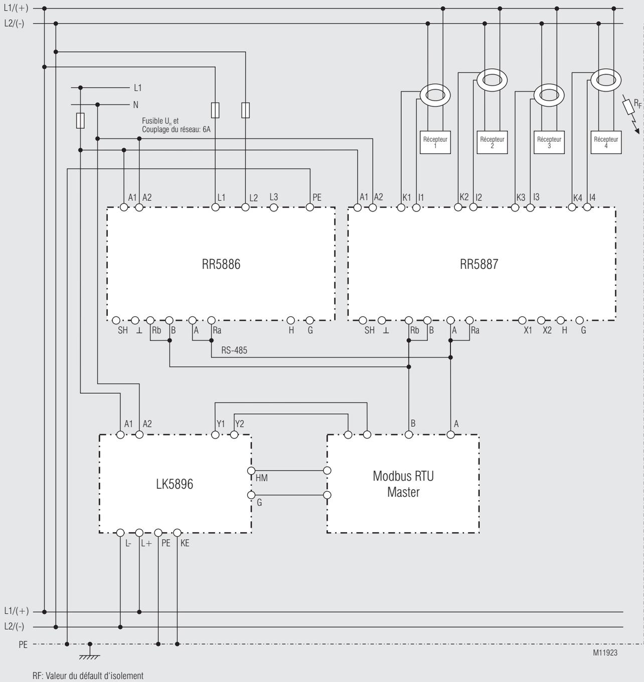
Contrôle de détection de défaut d'isolement avec Modbus Master externe
