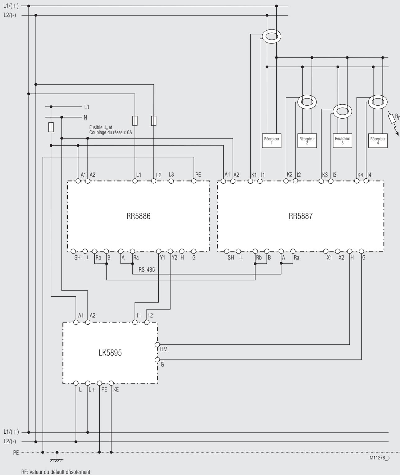
Surveillance de l'isolement et recherche d'erreurs d'isolement avec 4 transformateur d'intensité connectés dans un réseau AC (DC) avec distribution secondaire - la recherche des défauts d'isolement peut être commandée par le contrôleur d'isolement (LK 5895); terminaison du bus du premier et du dernier appareil au bus RS-485
