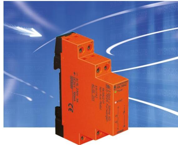
Das Not-Aus-Modul dient dem Schutz von Personen und Maschinen und kann sowohl ein- als auch zweikanalig beschaltet werden. Es ist geeignet für Anwendungen bis Performance Level e nach EN ISO 13849-1 sowie SIL 3 nach EN 61508 und EN 61511. Damit können von dem kleinen Not-Aus-Modul auch sicherheitstechnische Aufgaben in der Prozessindustrie übernommen werden.
