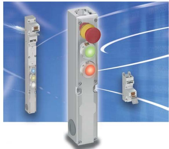
Das Optionsmodul kann direkt unterhalb von Schalter- und Zuhalteeinheiten formschlüssig installiert und über Steckverbinder schnell und einfach angeschlossen werden. Die schmale Bauform gestattet eine platzsparende Montage am Schutzzaun. Damit ermöglicht das Optionsmodul die direkte Befehlsausführung an Zugängen von Maschinen und Anlagen. Dies bedingt eine schnellere Bedienung der Befehlsgeber und eine deutliche
