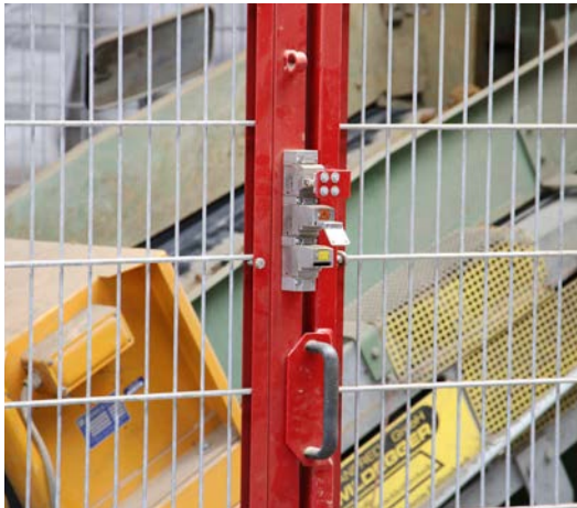
Die rein mechanisch arbeitende Zuhaltung an den Türen besteht aus Edelstahl und ist daher extrem robust.
