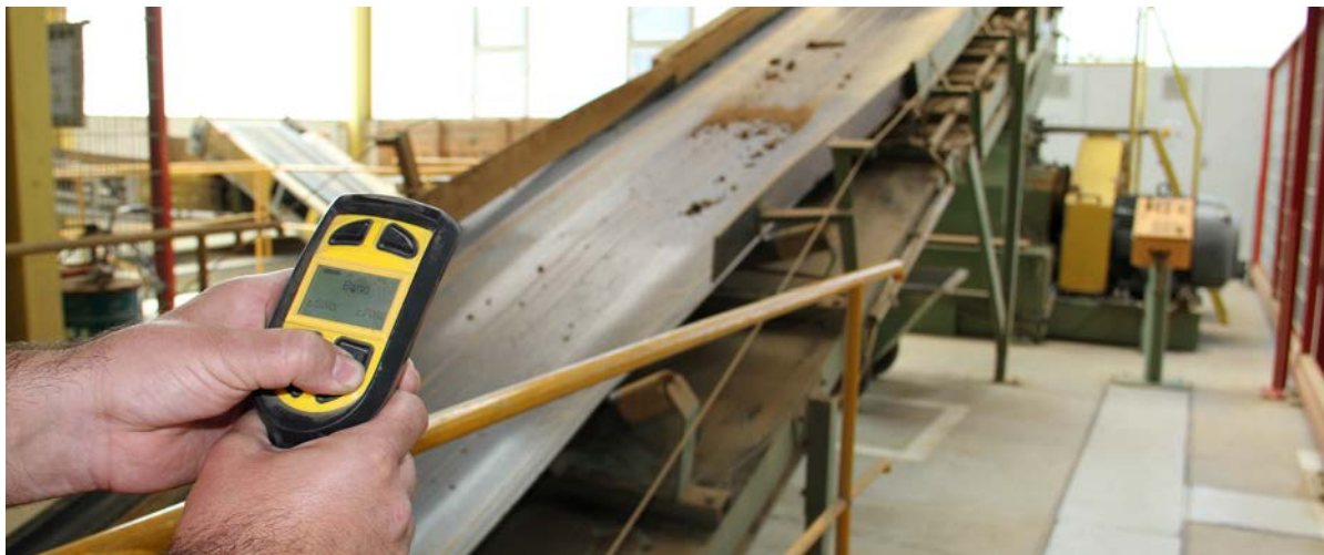
Mit dem Zustimmtaster der SAFEMASTER W Serie meldet sich der Mitarbeiter über Funk an und kann dann einzelne Antriebe gezielt anschalten.
