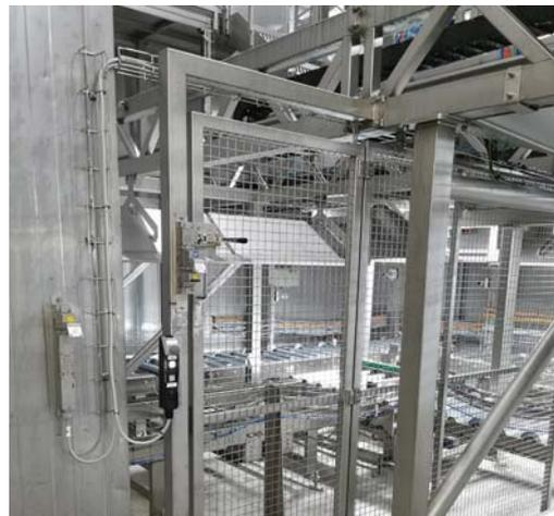
Die Türen sind mit dem SAFEMASTER STS System abgesichert.
