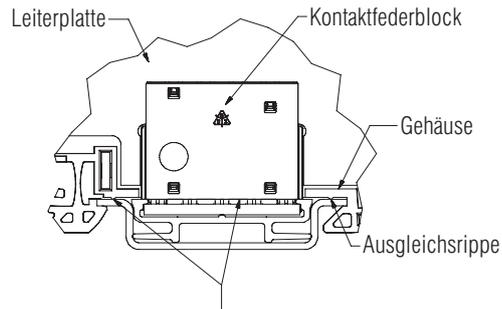
Achtung: Kontaktfederblock muss bündig zur Gehäuseunterkante bzw. Hutschiene positioniert sein, um einwandfreie Kontaktierung zu gewährleisten.
