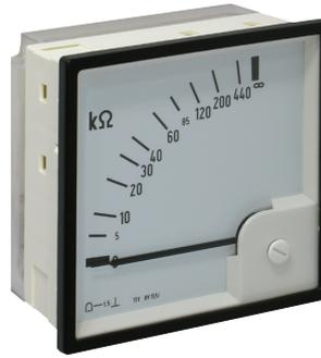
L'afficheur EH 5861 est branché extérieurement au contrôleur d'isolement sur les bornes d' UA / GA (0 - 10 V) et indique la valeur en kΩ à l'instant „t „, de la résistance d'isolement du réseau par rapport à la terre.
