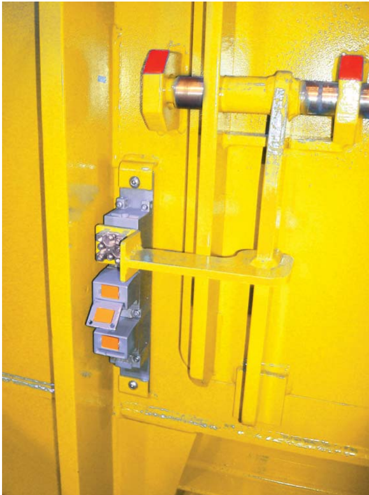
Schlüsseltransfersystem als Sperrvorrichtung
