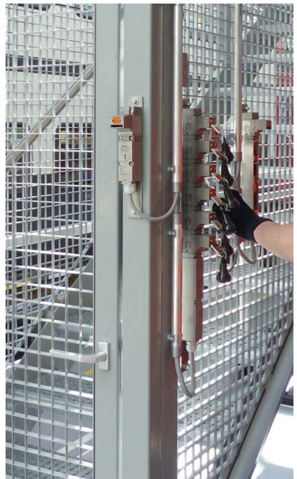
Elektromechanische Schutztürabsicherung mit Freigabe von 6 Schlüsseln zum Öffnen von verdrahtungslos abgesicherten Nebentüren
